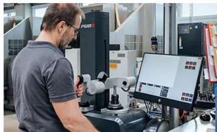
Das PWB Werkzeug-Voreinstellgerät: Ausgestattet mit den wichtigsten Standard Messfunktionen und für die Übertragung der Werkzeugdaten an die Bearbeitungsmaschinen ausgelegt.
